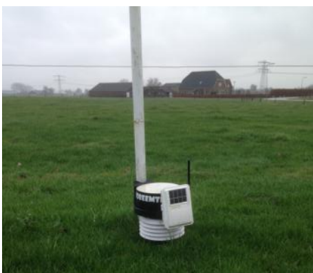
Instrument voor het meten van temperaturen vlak boven de grond.
